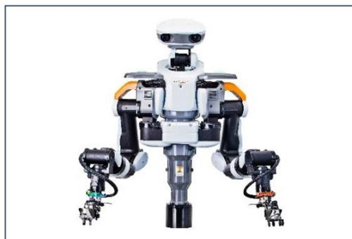
OriHimeとNEXTAGEを組み合わせることで、視線入力やスイッチなどのインターフェースを用いて、OriHimeの操作者（以下パイロット）がNEXTAGEを遠隔操作できるようになり、これまでのOriHimeだけではできなかった、バリスタやバーテンダーのような手作業ができるようになります。これにより重度肢体不自由の方でも、働き方の選択肢を広げ、その人が培ってきた技量や人間性を活かしながら、新たな社会参加の形の実現を目指します。
