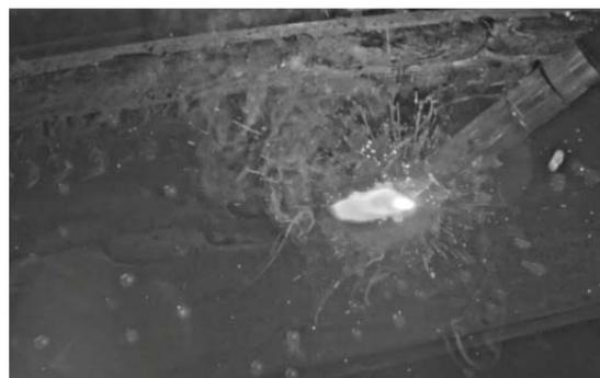
XDR 溶接部可視化技術による溶接作業の撮影画像
