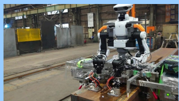
ロボットによる超音波探傷検査
