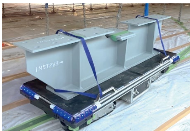
資材運搬用AGV
